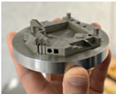
Möglich ist Vieles: 3D-Printing-Teil mit filigranen Stegen und Durchbrüchen.
